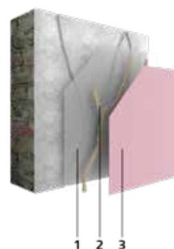
1 Grundbeschichtung 2 Rissverfüllung 3 Schlussbeschichtung
