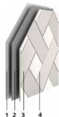
1 Grundbeschichtung 2 Verklebung 3 Bekleidung 4 Verfugung
