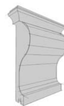
Supporti per davanzali StoDeco 03937-002 Spessore 40 mm Tipo PV-1000-653 Altezza 150 mm Lunghezza 130 mm
